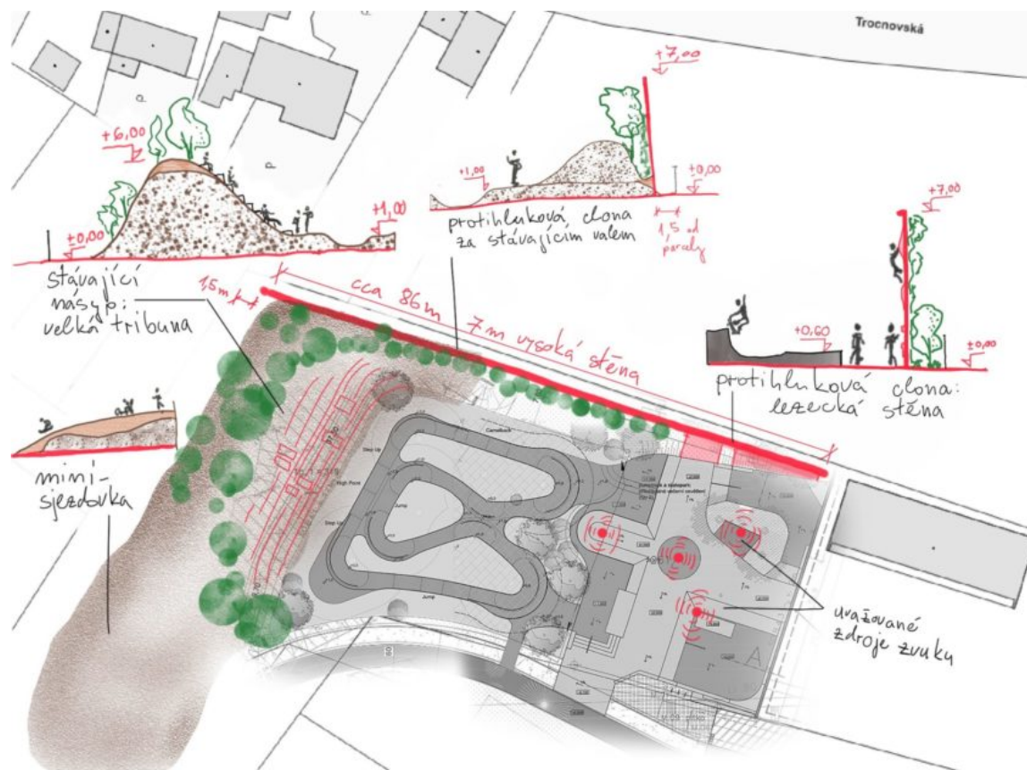
Protihluková stěna a jednostranná tribuna na svahu
